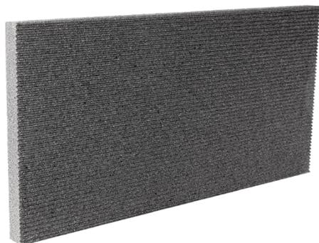
**Pannello isolante detensionato idoneo per l'applicazione a cappotto, realizzato in polistirene espanso sinterizzato EPS additivato di grafite, con zigrinatura esterna per migliorare la resistenza agli urti del sistema. Idoneo per i sistemi Termok8 A.R. Max 20J e 60J.**
